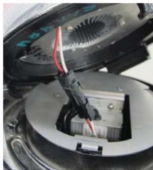
**STEP 5:** CONNECT ENGINE TO DRIVER ASSEMBLY
